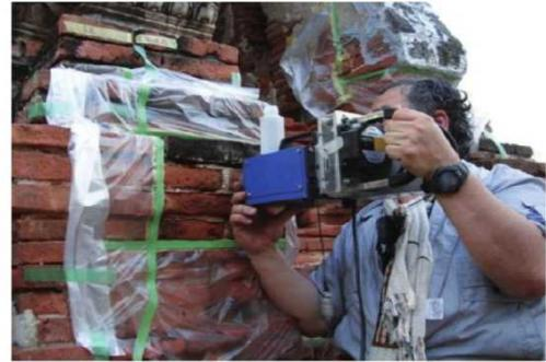
写真-13 ドリル削孔試験
