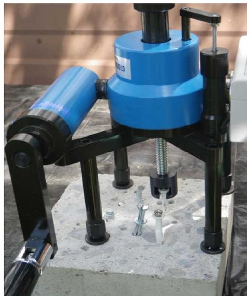
試験器で引張試験を行っている状況
