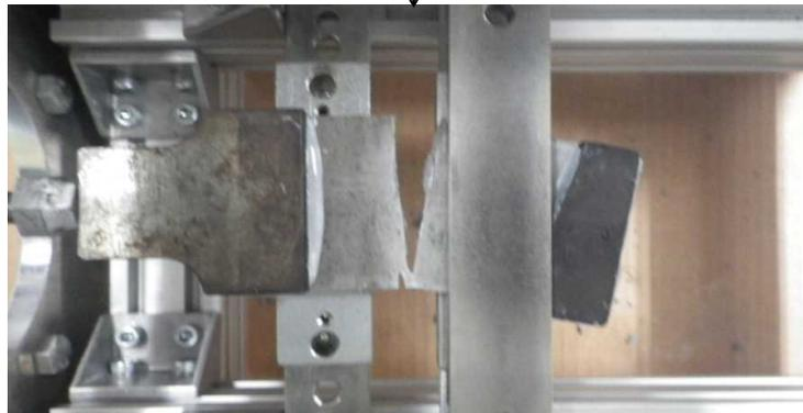
供試体破壊状況 (破壊後塗布面)
