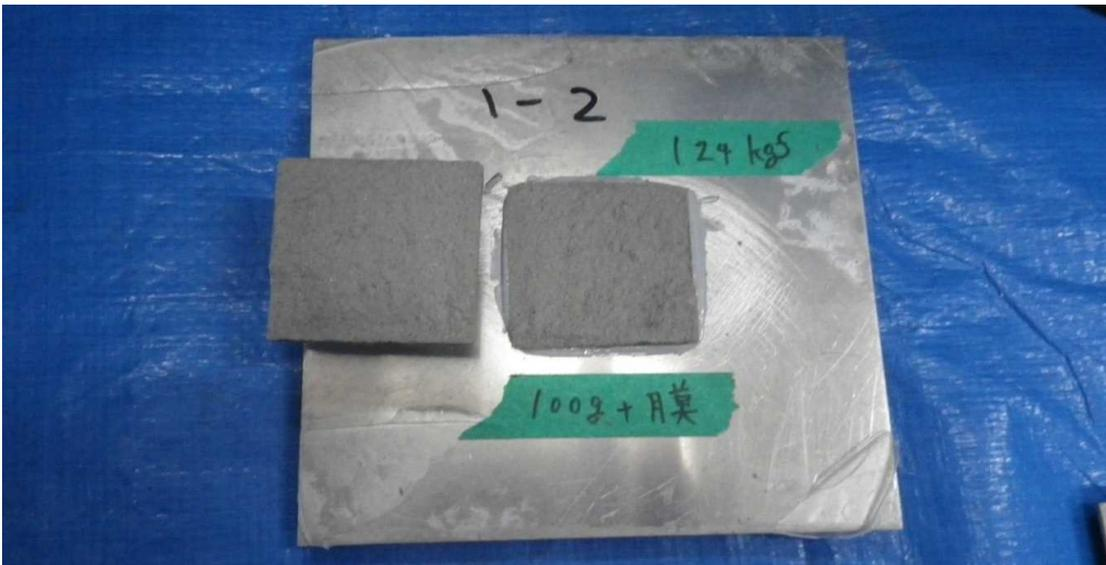
試験後供試体状況平面写真（モルタル内凝集破断）
