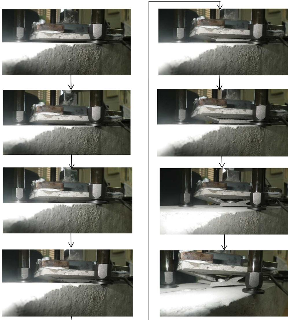
目地モルタル版破壊ステップ写真
