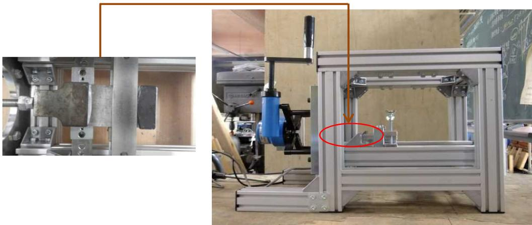
引張試験架台に設置された引張試験器と供試体の写真
